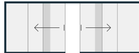
Verriegelung lösen und das Öffnungssegment schieben
